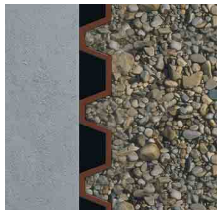
Обычные профилированные мембраны забиваются почвой и лишаются своей дренирующей способности.
